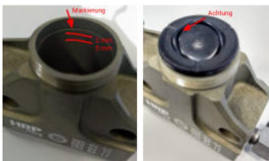
Die Ausgleichsmembran muss sauber aufliegen und darf nicht "verbogen sein". Nach dem Einsatz im Regen ggf. Feuchtigkeit zwischen Deckel und Ausgleichsmembran mit einem Lappen aufnehmen.
