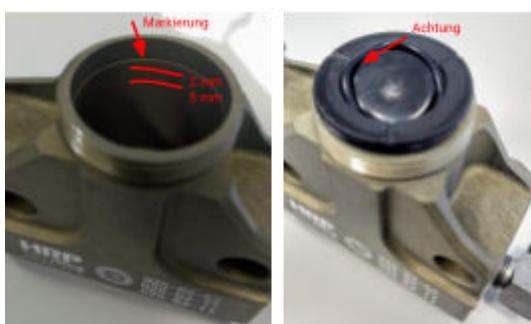
La membrane de compensation doit reposer proprement et ne doit pas être "pliée".
